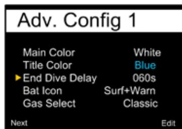
Cette option permet de déterminer le temps en secondes à attendre avant de terminer la plongée courante. Cette valeur va de 20 secondes à 600 secondes (10 min). Depuis, la console peut rester dans le mode plongée pour une durée plus longue, une nouvelle "End dive" a été ajoutée (chapitre: 6.11 Fin de plongée). C'est la 1ere option du menu quand la console est encore en mode plongée et quand le plongeur est en surface.
