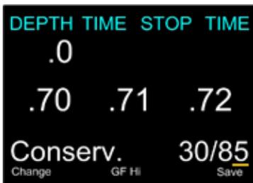
Paramétrer le gradient de facteur haut (affichage "GF Hi". Un seul chiffre changé à la fois. Les dizaines sont toujours paramétrées d'abord. En appuyant sur le bouton de gauche "Change" le chiffre s'incrémente de 1. Après le chiffre 9 il retourne sur 0. Presser le bouton de droite "Next" une fois pour aller sur les unités.
