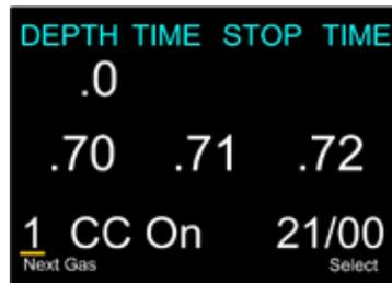
Avec ce choix de menu il est possible de choisir un des gaz prédéfinis. Le gaz sélectionné est utilisé comme diluant en mode circuit fermé (CC) et comme gaz respirable en mode circuit ouvert (OC).
