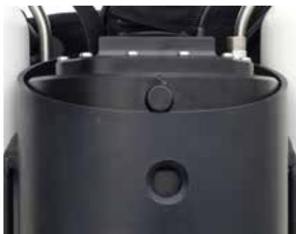
Alignez la tête pour que le poussoir et le trou du tube aluminium soient alignés.
