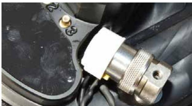
Le recycleur JJ-CCR utilise un solénoïde spécifique qui se caractérise par une très basse consommation d'énergie. Avec ce solénoïde, S'il est en panne il reste en position fermée. Cela réduit complètement le risque potentiel d'une injection d'oxygène toxique dans le cas d'un dysfonctionnement.
