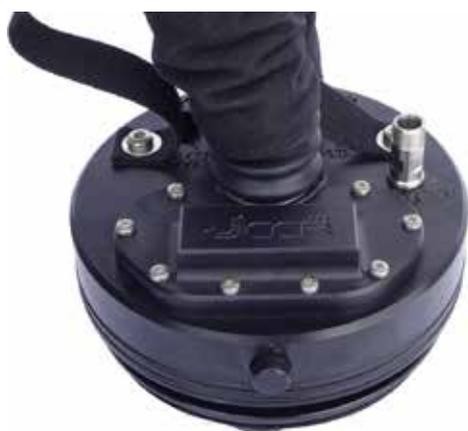
La tête avec les trois capteurs, solénoïde, compartiment batterie et connecteurs de la console et HUD est le cerveau du recycleur JJ-CCR. Du côté main droite se trouve la connexion pour l'oxygène basse pression au solénoïde. Le compartiment des batteries se trouve sous le capot où est gravé 'JJ CCR'.
