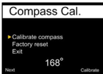
A l'aide de ce menu vous pouvez calibrer le compas ou remettre les paramètres d'usine. Pour calibrer le compas : appuyer bouton de droite "Calibrate" et effectuer la rotation dans les 3 plans de l'espace durant 15 secondes : retournement, côtés, bords etc.
