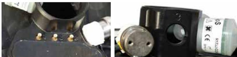
Le branchement des capteurs avec les connexions de la tête doivent être faites correctement dans l'ordre des numéros car les séquences correspondent à l'affichage sur la console et sur le HUD.
