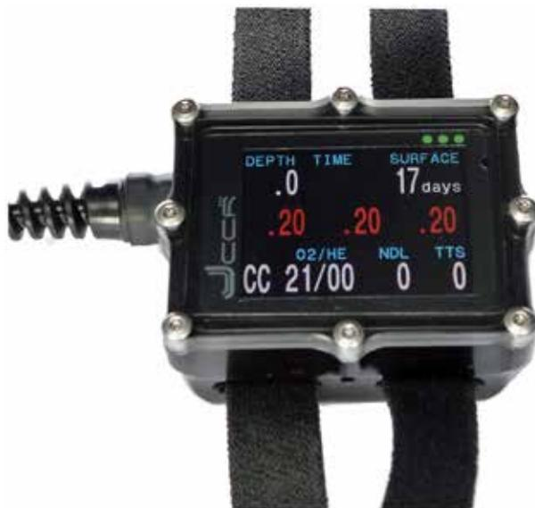
La console est connectée à la tête du recycleur JJ CCR via une prise résistante à l'eau. Un grand affichage à haute résolution LCD couleur est visible sur le dessus.
