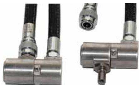
L'injecteur manuel de diluant apporte du gaz diluant au circuit respiratoire. Plus le bouton reste enfoncé plus il y a d'injection de diluant dans le circuit. Une légère pression sur le bouton provoque l'injection d'une petite quantité de diluant, donc appuyer plus longtemps sur le bouton apporte plus de diluant. Il est possible de déconnecter le flexible et de procéder à une rotation de 180° de l'injecteur, de façon à connecter une autre source de gaz, externe.
