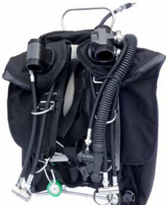
Le tuyau annelé avec le flexible sont connectés de la wing à l'inflateur, et l'ensemble est retenu en passant passé à travers de l'élastique du harnais. De cette façon l'inflateur reste toujours dans la même position durant la plongée.
