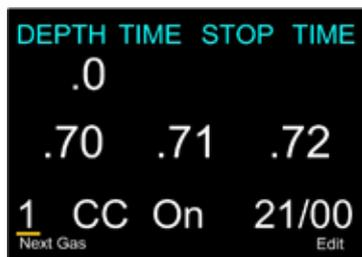
Appuyer sur le bouton de gauche "Next Gas" amène à l'affichage du gaz suivant. Les gaz sont numérotés de 1 – 5. La séquence dans laquelle les gaz sont renseignés est inappropriée. Dans le menu "Select Gas" tous les gaz disponibles sont affichés en fonction de leur PPO2 (de la plus haute à la plus basse). Si deux gaz ont la même PPO2, alors le gaz qui a le plus petit contenu en hélium est affiché en haut de séquence.
