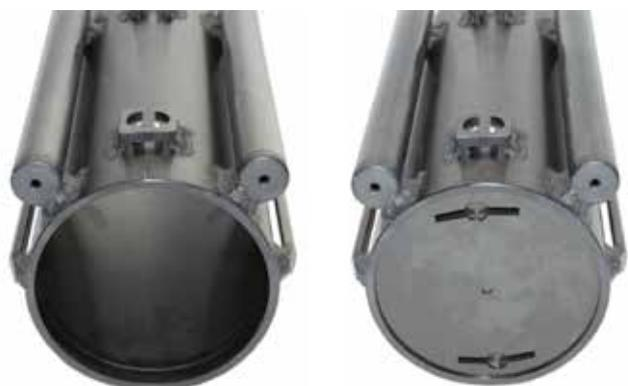
Lors de la fixation du support il faut insérer la plaque de fond à l'unité de base ci-contre. Avant l'insertion du fond assurez-vous que les portées d'étanchéité de l'unité de base sont propres. Vérifier attentivement les deux joints de la plaque de fond et graisser à nouveau si nécessaires. Dans ce cas ne déposez pas trop de graisse silicone mais simplement appliquer une fine couche. L'insertion de la plaque de fond ne doit pas se faire en force et avec un effort excessif.
