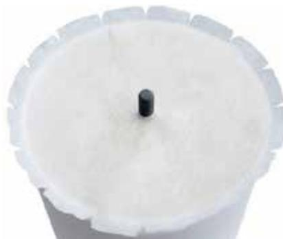
3. Remplissez à nouveau jusqu'à arriver à 4-5 mm du bord. Tapotez à l'extérieur canister et tout autour de façon à niveler la chaux ou la tasser. Puis placer le second filtre hydrophobe à poussières par-dessus de la chaux.
