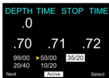
Durant une plongée qui comporte des paliers de décompression, en entrant dans le menu SELECT GAS, le premier gaz pointé sera le plus approprié à la profondeur (c'est-à-dire PPO2 inférieure à 1.60 bars). Cela réduit le nombre de pressions sur le bouton poussoir dans la plupart des cas. A la surface et quand il n'y a pas de palier, le premier gaz pointe sera le gaz actif. Notez que cela change du style habituel classique où la première sélection est toujours le gaz le plus haut en % d'O2.
