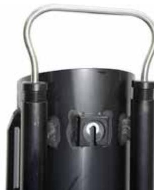
Il est possible d'utiliser deux types de poids. Les uns pourront opter pour de la grenaille de plombs ou des barres de plombs. Si de la grenaille est utilisée alors il faut d'abord insérer un petit morceau d'éponge dans les tubes. Cela évite à la grenaille de tomber. Dans le même temps, l'éponge permet à l'eau de s'évacuer.
