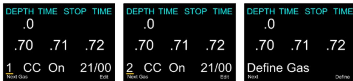
Appuyer sur le bouton de gauche "Next Gas" bascule sur le gaz suivant. Si le numéro du gaz est précédé d'un "A" alors c'est le gaz actif. Il est possible de l'ajuster mais pas de l'effacer (0% O2 et 0% HE)
