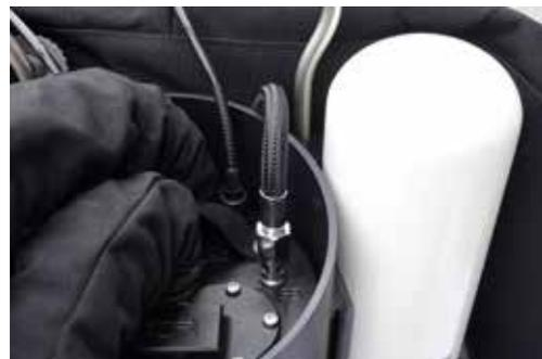
Maintenant connectez le flexible basse pression d'oxygène, **serrez uniquement à la main!**
