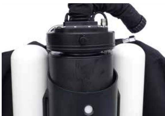
Avant de placer la tête et le canister dans le tube aluminium, les deux joints doivent être inspectés avec attention et re-graissés si nécessaire. Ne mettez pas trop de silicone mais appliquez une légère pellicule. Il faut être attentif à ce point important sinon il peut y avoir une fuite qui causera de graves dommages au recycleur.
