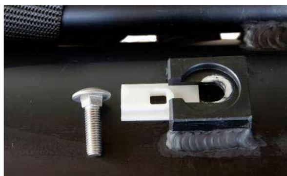
L'image ci-dessus montre comment la vis (vis de verrouillage M8x30) est insérée dans le dispositif de retenu de vis. Les deux supports de vis sont faits de façon à ce qu'un desserrage non intentionnel du montage n'entraîne pas la chute de l'unité de base. La pièce en plastique forme une protection galvanique entre l'aluminium de l'unité de base et l'acier inoxydable de la vis. Cela évite la corrosion. La wing, faux poumons et plaque seront fixés aux vis ultérieurement.
