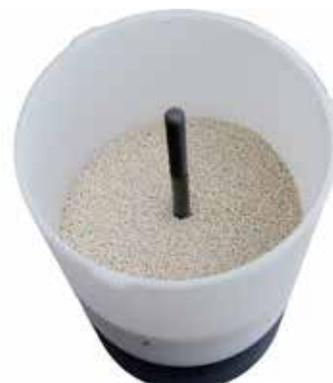
2. Remplissez à moitié le canister avec de la chaux sodée. Tapotez sur l'extérieur tout autour, de façon à niveler ou la tasser.
