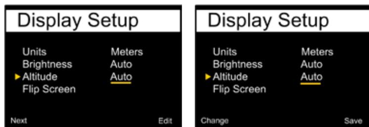
Via cette option on peut switcher automatiquement l'ajustement de l'altitude sur on ou off. Si l'option est paramétrée "Auto", alors il y a ajustement automatique de l'altitude (En mode lacs montagne) pour la décompression et la calibration des capteurs O2.
