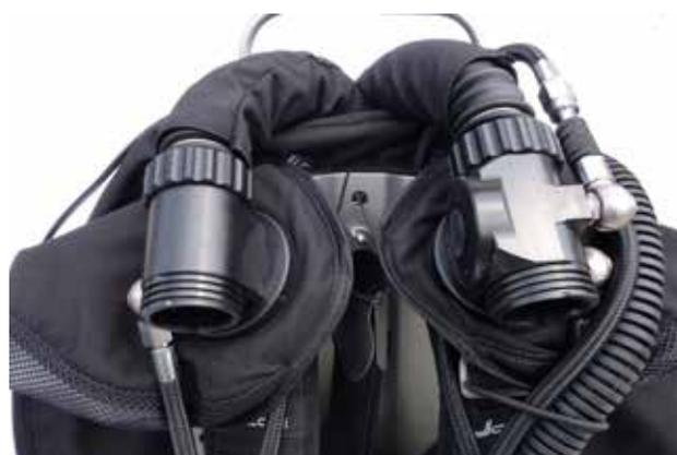
Connectez les tuyaux respiratoires aux pièces en T et ADV. Il n'est pas possible de les connecter en faisant une erreur car les connexions sont différentes (détrompeurs). La connexion du côté inhalation (ADV) est dans le sens des aiguilles d'une montre, alors que la connexion du côté expiratoire (pièce en T) est dans le sens inverse des aiguilles d'une montre.
