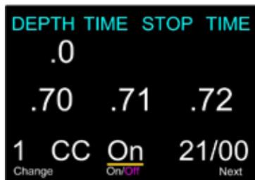
Appuyer sur le bouton de droite "Edit" on édite le gaz. D'abord il faut sélectionner si un gaz sera actif (=On) ou non actif (=Off). Les gaz actifs sont utilisés pour prévoir la TTS (temps total vers surface) et le switch des gaz. Pour cela il est essentiel de définir uniquement les gaz courants disponibles.
