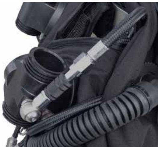
Connecter le flexible le plus court avec la vanne d'arrêt d'alimentation dite "shut-off" ou "flow stop" du 1er étage, avec l'ADV.
