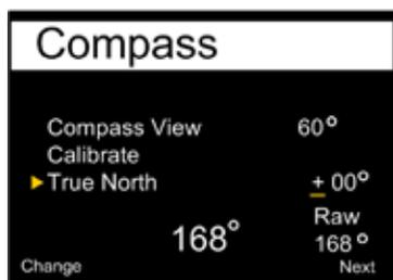
Dans la plupart des endroits, le compas ne pointe pas vers le Nord vrai, mais plutôt vers le Nord magnétique. La différence d'angle entre ses deux directions est appelée la déclinaison magnétique (ou variation magnétique), et varie tout autour de la Terre. La déclinaison à l'endroit où vous êtes peut être trouvé sur les cartes ou sur internet.
