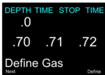
Ce choix menu permet de paramétrer les gaz respirables utilisés. La console permet au plongeur de paramétrer 5 gaz différents en mode OC circuit ouvert, et 5 gaz différents en circuit fermé CC.
