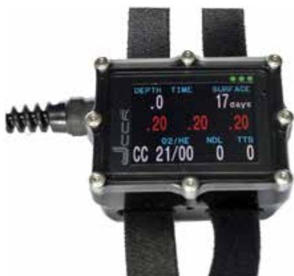
Le recycleur JJ CCR est fourni avec une console PETREL SHEARWATER, qui contient un ordinateur de décompression multi gaz (nitrox, trimix, heliox) et multimode (OC circuit ouvert et CC circuit fermé). Le firmware installé dans l'ordinateur est optimisé pour le JJCCR et contient des capacités et fonctions spécifiques à cet équipement.
