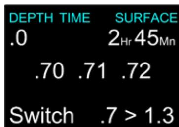
Par exemple: Si l'utilisateur presse sur le bouton droit (select) dans le menu SWITCH SET POINT, alors le SET POINT passe à 1.3 (ex : 0.7 à 1.3).
