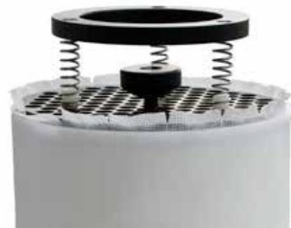
4. placez la plaque à ressort sur le filtre et serrez la vis, jusqu'à serrage complet à la main. Ensuite tapotez tout autour sur l'extérieur du canister pour niveler ou tasser la chaux. La visse peut en générale être à nouveau serrée un peu à la main. ATTENTION ne serez pas de manière excessive la vis car cela peut endommager le canister. Le canister est correctement rempli quand il ne résulte aucun bruit venant des granules de chaux en le secouant.
