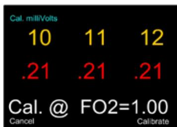
Les capteurs d'oxygène sont à calibrer à partir de ce menu. La console pour le recycleur JJ CCR à une séquence de calibration qui se déroule automatiquement.
